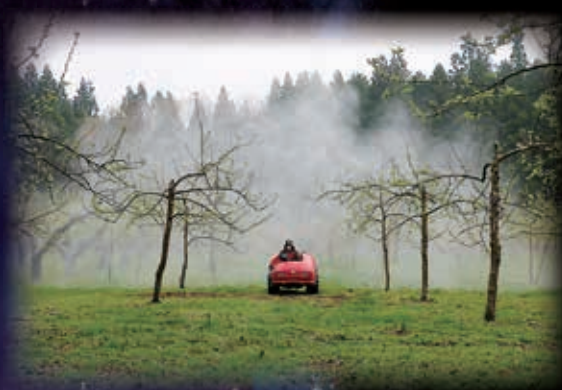
走行している列とその次の列にも薬液は飛散している
