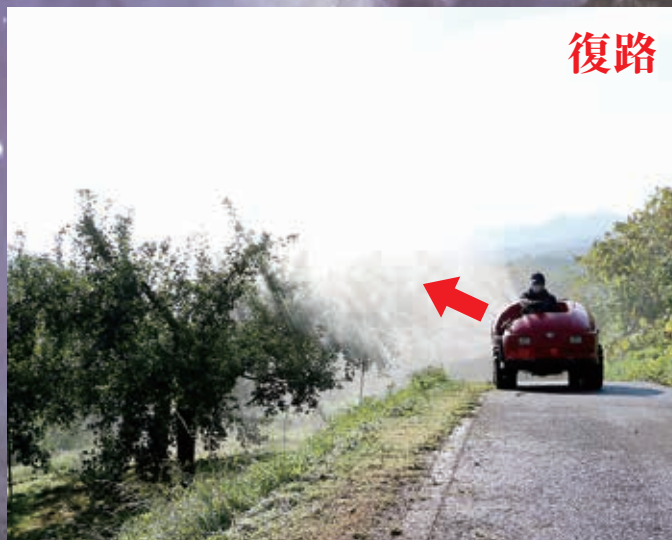
葉の表面にも十分薬剤が付着するように復路（補助散布）も実施し、散布ムラをなくすることが大切
