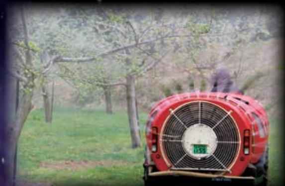
適正風量で散布量の濃淡が出ない様にする
