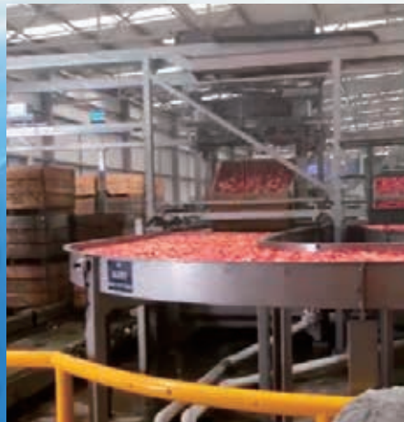
収穫ビンを反転し、果実を洗浄層へ入れる
